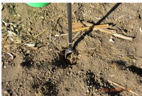
Figura 4. Perforacion con barrena.
